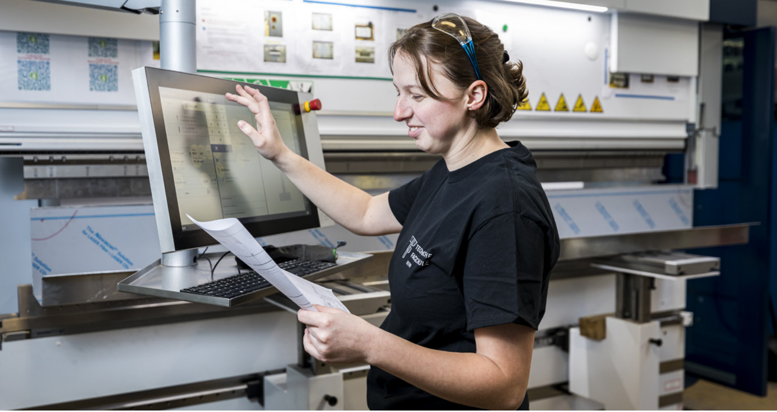
Handwerk und modernste Technik: Eine Lernende bedient die neue hydraulische CNC-Abkantpresse der Technischen Fachschule Bern.
